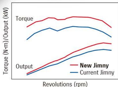
Motor 1.5 L com bloco de alumínio, 108 CV de potência, 14,1 Kgf.m de torque e comando de admissão variável
