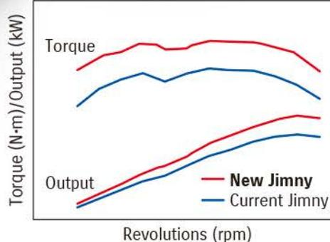
Motor 1.5 L com bloco de alumínio, 108 CV de potência,
